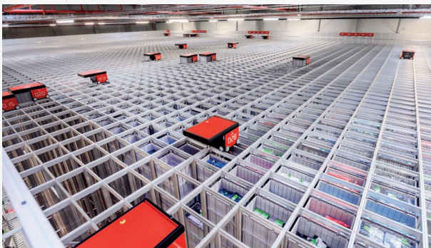
Het middelpunt: het AutoStore-systeem met meer dan 50 robots. Deze begeleiden in totaal 150.000 kisten met meer dan 3,5 miljoen producten.
