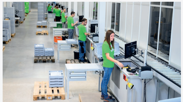
De robots brengen de kisten naar onze medewerkers bij de verzamelstations om de bestelling klaar te maken. Daar worden per dag ongeveer 1000 opdrachten verzameld.
